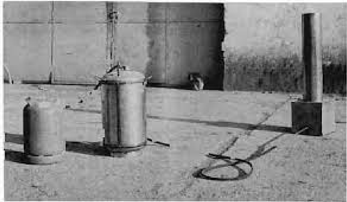
Generador de iodur de plata dissolt en acetona, com el instal·lat a l'Ermita de Sant Josep.
